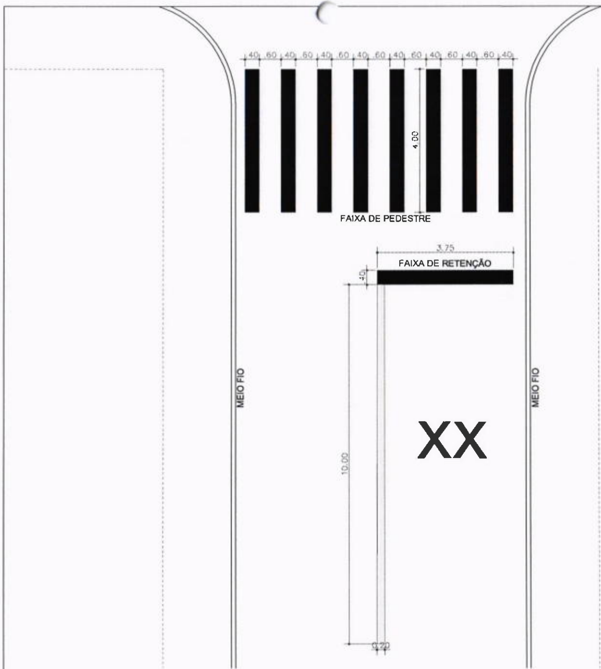
SINALIZAÇÃO HORIZONTAL – Detalhe Genérico ESCALA 1:100
