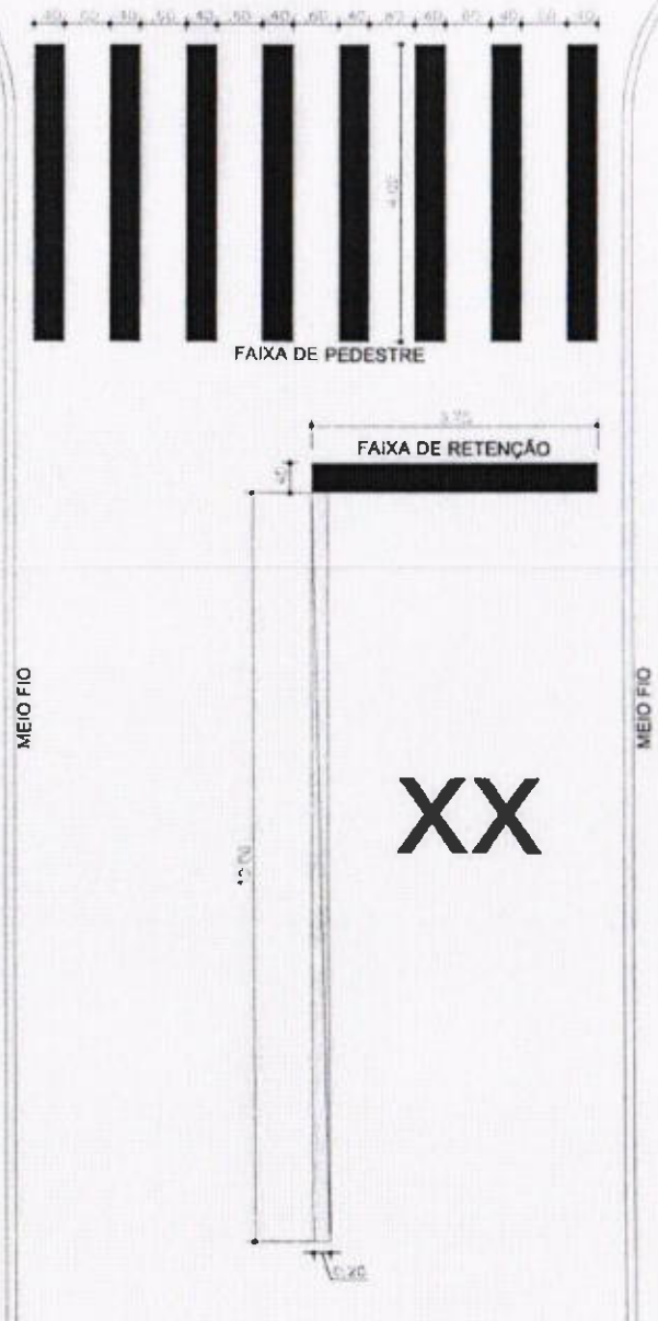
SINALIZAÇÃO HORIZONTAL – Detalhe ESCALA 1:100
