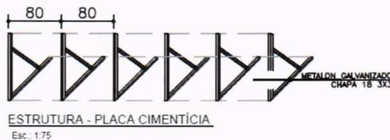
Figura 21: Detalhamento da estrutura. Metalon 3x3 chapa 18.
