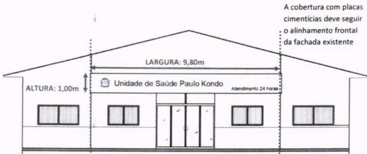
Figura 12: Detalhamento cobertura da fachada da Unidade de Saúde Paulo Kondo em Placas cimentícias.
