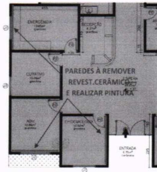
Figura 03: Planta baixa localização da troca de revestimento cerâmico de paredes Fonte: A autora, 2022.
