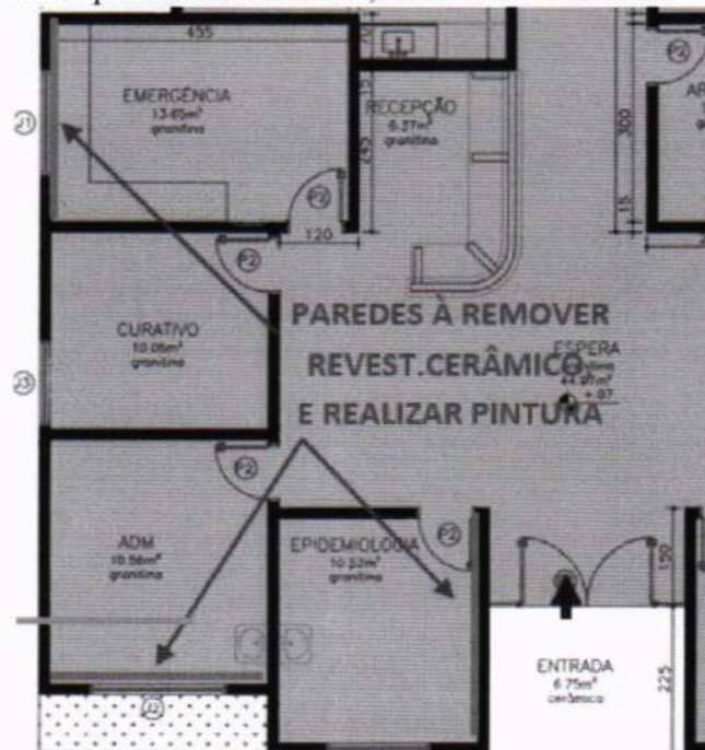
Figura 03: Planta baixa localização da troca de revestimento cerâmico de paredes Fonte: A autora, 2022.
