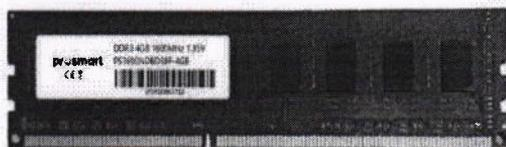
Os módulos SDRAM DDR3 Prosmart® são módulos de memória de acesso aleatório dinâmico CMOS de alta velocidade que usam dispositivos SDRAM DDR3 de 8 bancos configurados internamente. Os módulos SDRAM DDR3 usam a arquitetura DDR para obter uma operação de alta velocidade.
