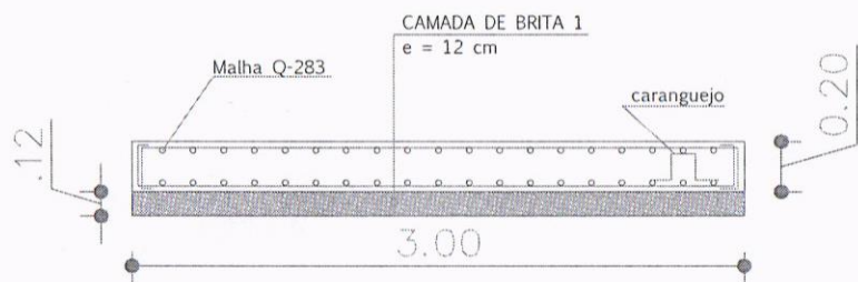
BALDRAME TIPO RADIER - Corte transversal N= 0.00 ESCALA 1:40
